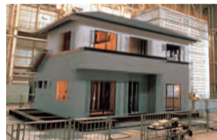
多度津工学実験所での実大振動実験
