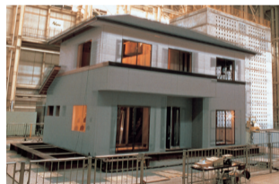
多度津工学実験所での実大震動実験
